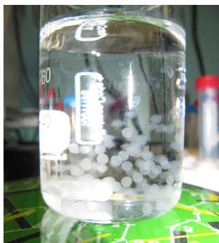
Fig. 24. Sfere ottenute gocciolando l'alginate in cloruro di calcio.
