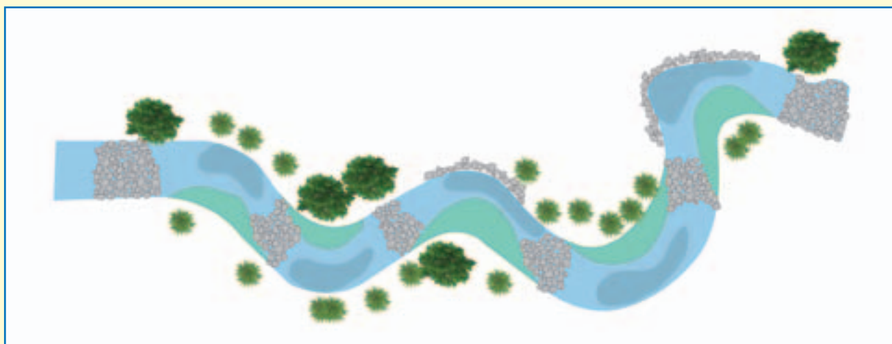
Figura 1.27 – Sezione e andamento planimetrico tipici di un canale di tipo naturalistico scavato ex-novo . Il profilo trasversale dell'alveo a più stadi (in alto) degrada dolcemente passando dal piano campagna all'alveo di magra, ospita vegetazione acquatica ed arboreo-arbustiva e può essere soggetto a evoluzione morfologica nel corso del tempo; l'andamento planimetrico (in basso) è sinuoso e l'alveo è morfologicamente diversificato grazie alla presenza di buche, raschi, depositi di sedimenti, ecc.
