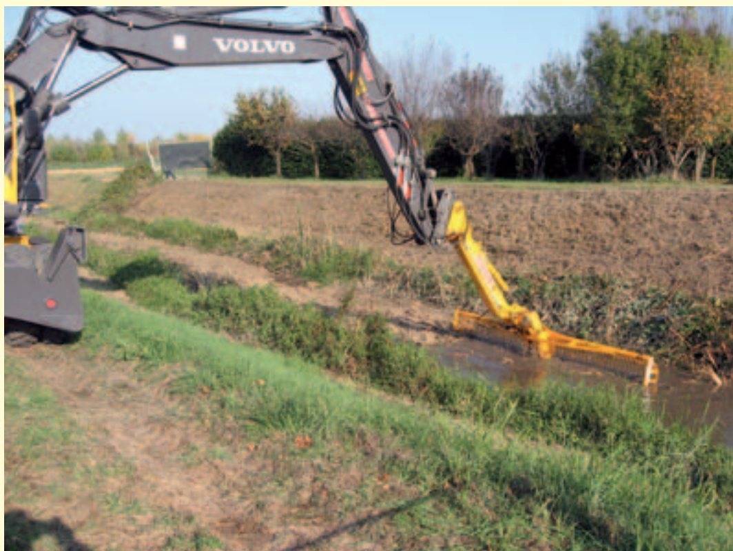
Figura 5.3 – Benna falciante montata su escavatore. (Fonte: Consorzio di Bonifica Acque Risorgive).
