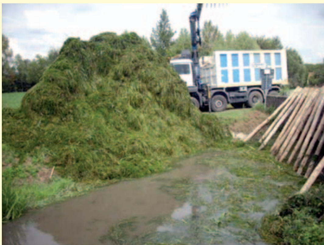
Figura 5.4 – Recupero della vegetazione mediante autocarro dotato di gru a braccio articolato con apposita "forca prensile". (Fonte: Consorzio di Bonifica Acque Risorgive).
