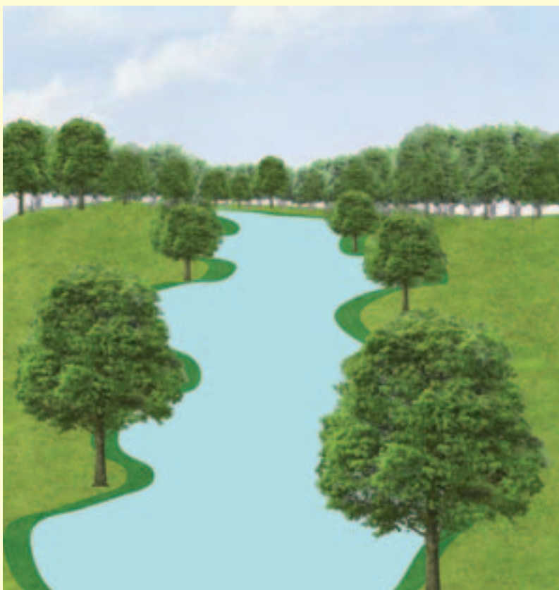
Figura 3.6 – Intervento per l'incremento della sinuosità di un canale rettificato, al fine di aumentare il tempo di residenza delle acque.
