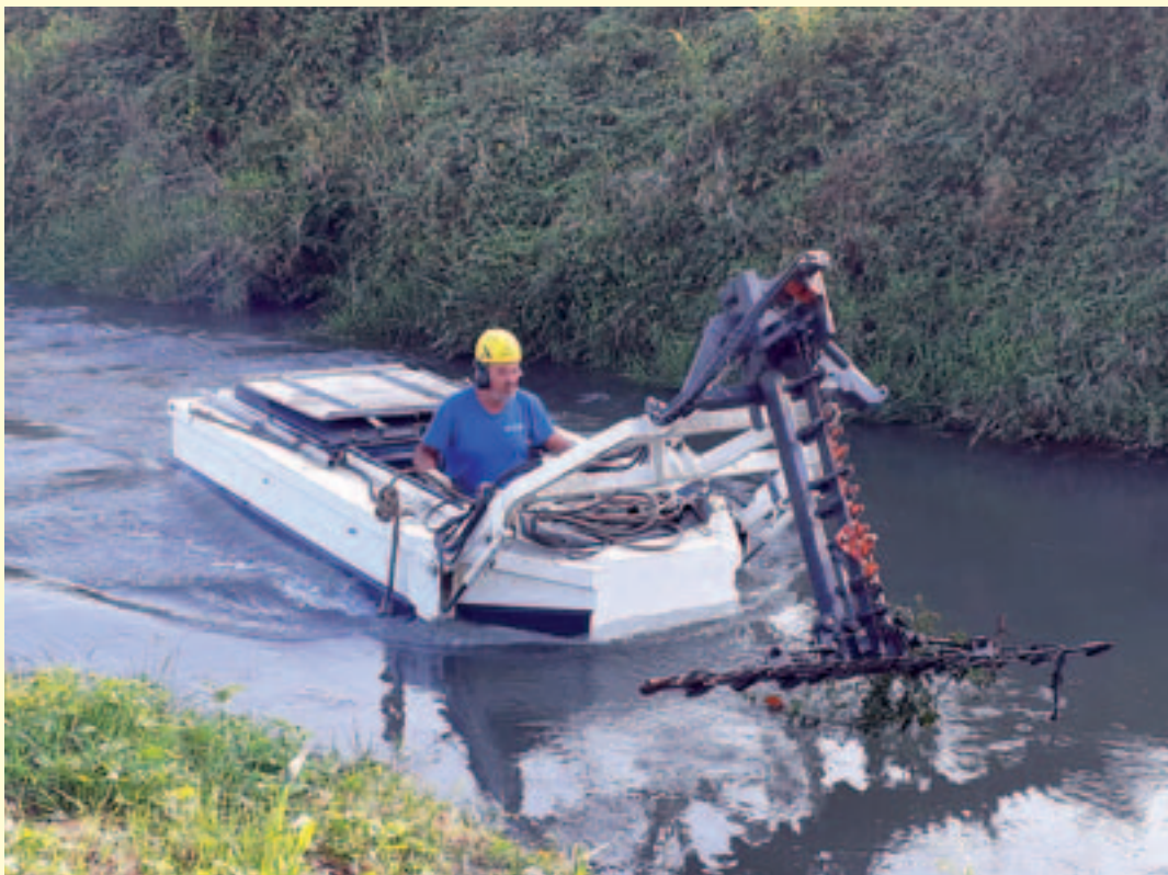
Figura 5.2 – Barra falciante montata su imbarcazione. (Fonte: Consorzio di Bonifica Acque Risorgive)
