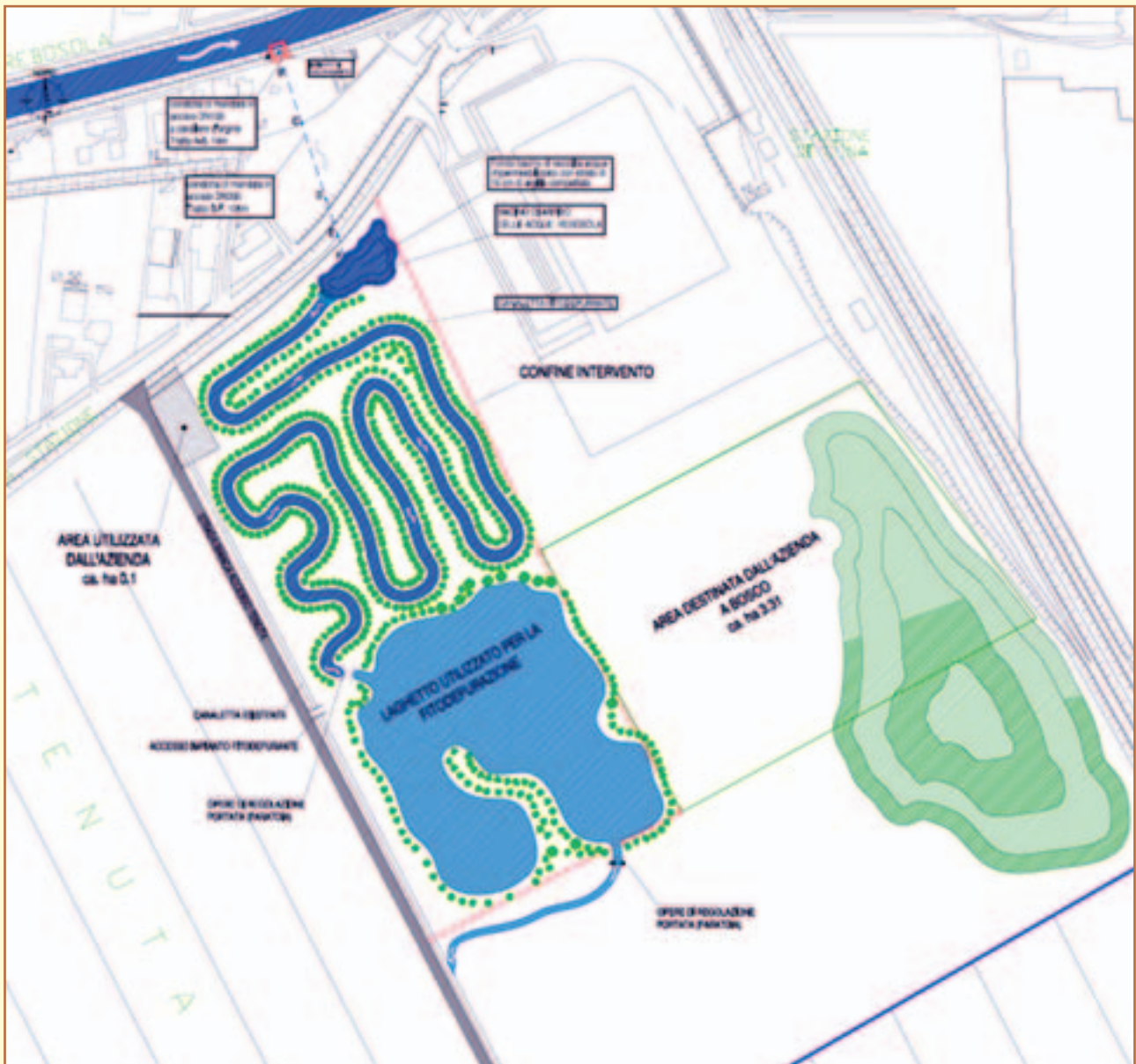
Figura 3.20 – Zona umida Canale Rebosola. Nelle immagini è possibile apprezzare lo schema di progetto e i lavori di scavo a profondità diverse dell'area. (Fonte: Consorzio di Bonifica Adige Euganeo)
