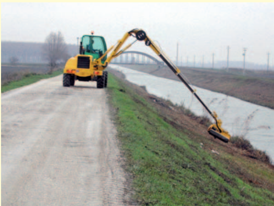
Figura 5.18 – Nella foto in alto si nota la banchina ricreata sulla Fossa Maestra e in basso lo sfalcio della vegetazione spondale nella sponda originaria, di forma trapezia. (Fonte: Consorzio di Bonifica Veronese)
