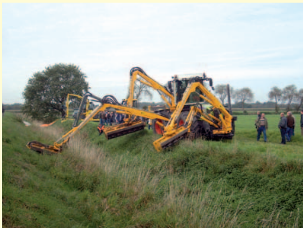
Figura 5.7 – Mezzi d’opera appositamente progettati per la gestione della vegetazione lungo i canali. (Fonte: Consorzio di Bonifica Acque Risorgive).
