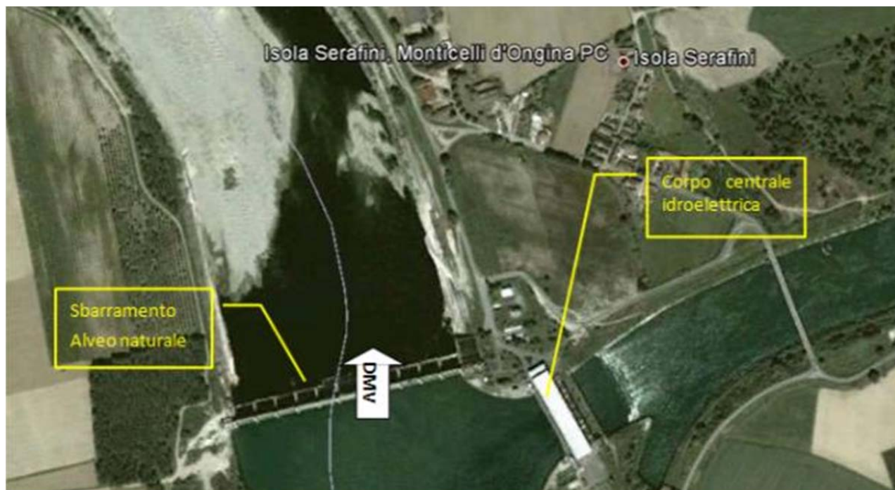
Particolare dello sbarramento. In destra idrografica la centrale che genera il ramo artificiale che sfrutta il salto idraulico dato dal taglio di meandro. In sinistra idrografica lo sbarramento sull'alveo naturale e l'alveo a valle dello stesso generato dal rilascio del Deflusso Minimo Vitale.
