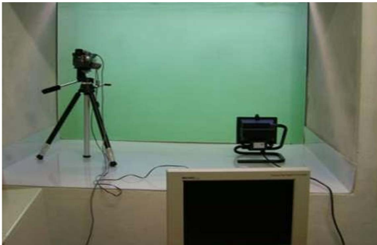
Figura 14 Immagini di una cabina di monitoraggio recentemente realizzata, che permette la registrazione video dei transiti dei pesci.
