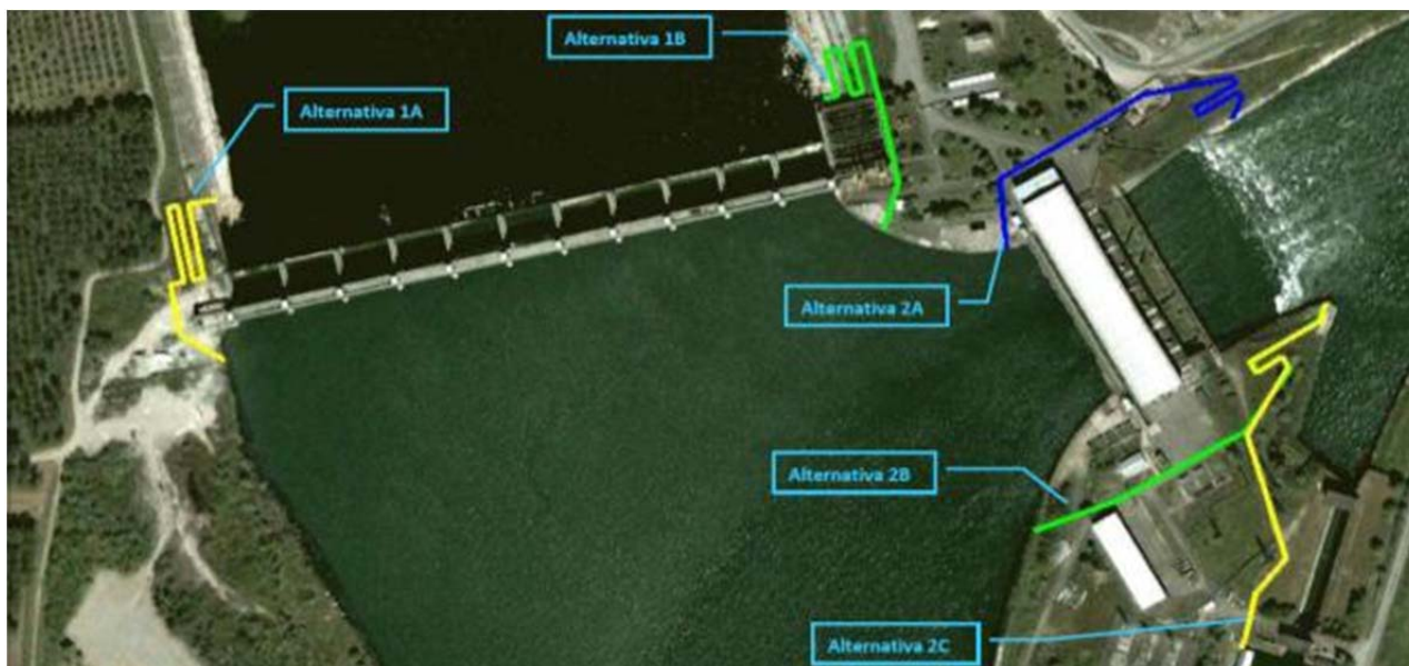
Inserimento schematico planimetrico delle 5 soluzioni vagliate preliminarmente alla determinazione della scelta da percorrere nello sviluppo del progetto.
