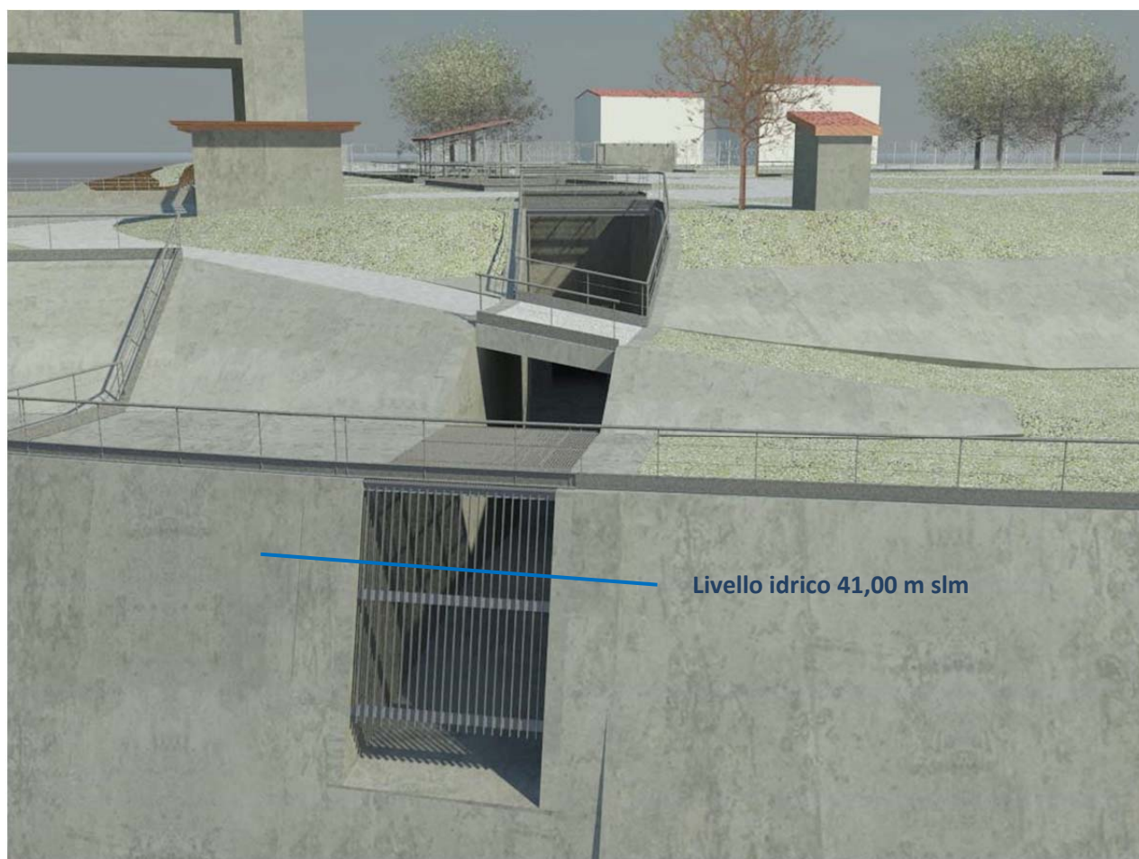
Figura 7 Imbocco di monte con griglia grossolana.
