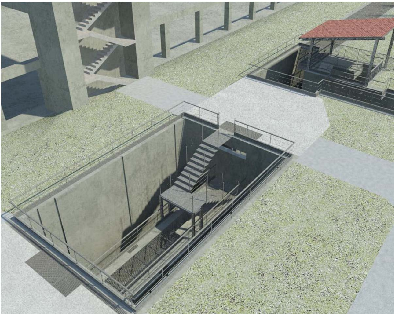
Figura 16 Vista dall'alto del sistema di cattura e della scala di accesso dal piano campagna.
