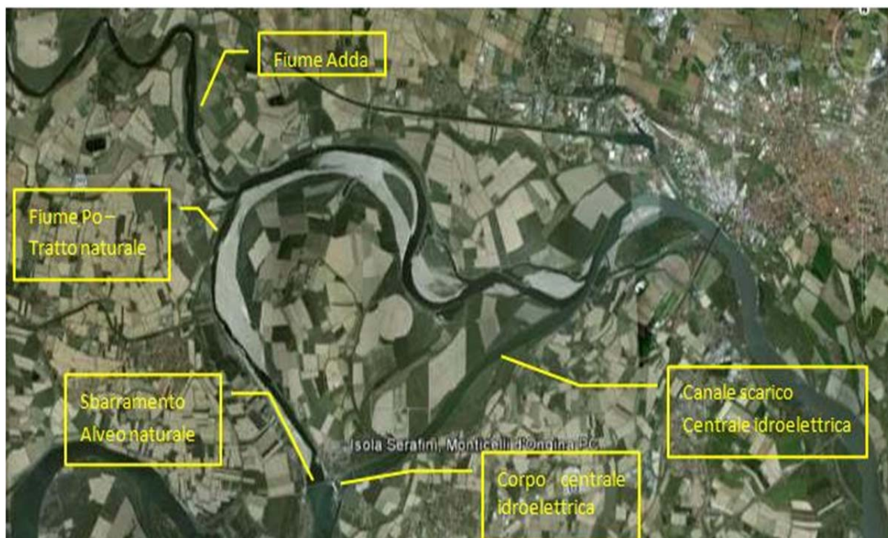
Reticolo idrografico nelle adiacenze di Isola Serafini. Ben visibile il taglio di meandro generato dal ramo di rilascio idrico generato dalla centrale idroelettrica.
