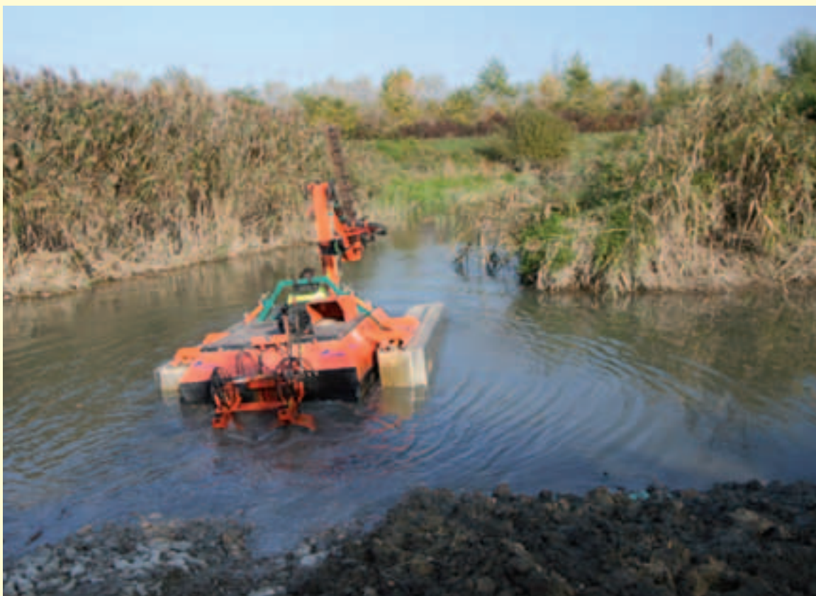
Figura 5.7 – Mezzo anfibia per la manutenzione dei canali operante in appoggio sul fondo del canale (in alto) oppure come natante (in basso) in presenza di un sufficiente tirante idrico. (Fonte: Consorzio di bonifica Acque Risorgive).
