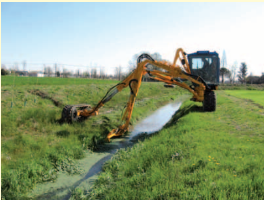
Figura 5.6 – Mezzo d'opera specifico per le attività di manutenzione nei corsi d'acqua. (Fonte: Consorzio di bonifica Acque Risorgive).
