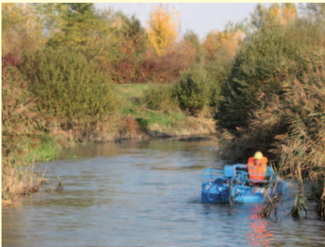
Figura 5.5 – Per la manutenzione dell'alveo può essere impiegata la barra falciante montata su un'imbarcazione. (Fonte: Consorzio di bonifica Acque Risorgive).
