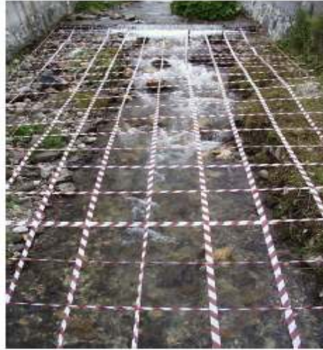
Figura 7: esempio di campionamento superficiale utilizzando il metodo a reticolo (grid-by-number). Le misure dei diametri vengono effettuate sui singoli elementi localizzati in corrispondenza dei nodi della maglia.
