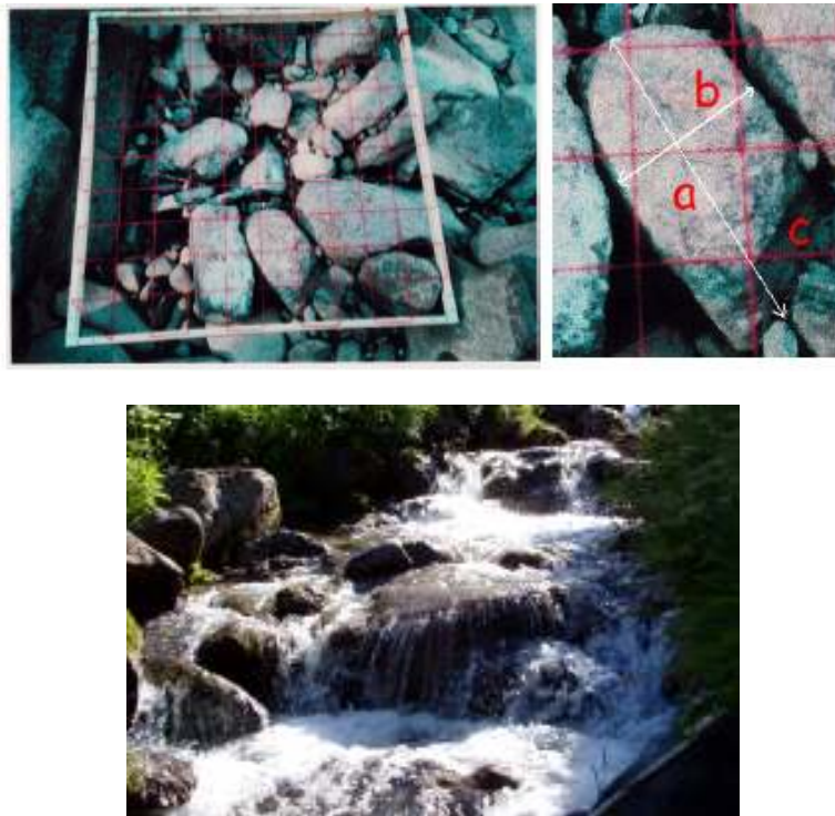
Figura 5: letto di un torrente montano. Caratteristiche dello strato superficiale, costituito da granulometrie grossolane ed eterogenee. Ogni elemento (ciottolo) è caratterizzato da tre assi principali; il diametro di riferimento per la classificazione granulometrica corrisponde al diametro dell'asse medio (asse b).
