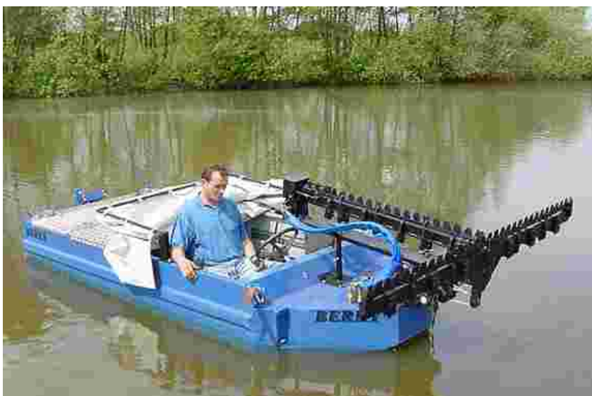
Figura 7.9: natante equipaggiato con barre falcianti utilizzato per il diserbo del fondo di corsi d'acqua e grandi canali.
