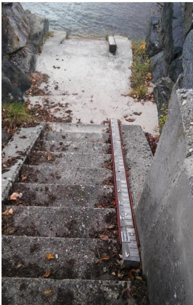
**Fig.4-21:** Dettaglio dell'asta idrometrica inclinata della stazione idrografica di Thörl.
