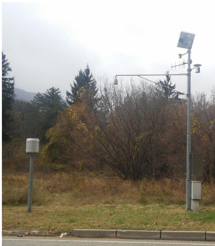
**Fig.4-1:** Stazione di monitoraggio meteorologico composta da pluviometro, termometro, igrometro, nivometro, radiometro, barometro ed idrometro a ultrasuoni posizionata in corrispondenza del ponte di attraversamento del torrente Slizza in località Campo sportivo di Tarvisio
