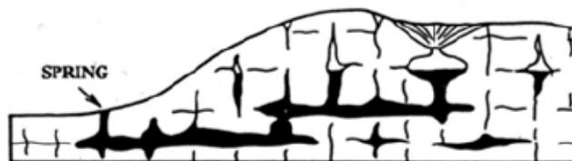
**Fig.1-8:** Sezione schematica di una sorgente tubolare (da Abramson,2002).
